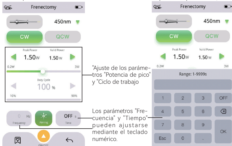
Figura 17: Esquema de la interfaz de parametrización
