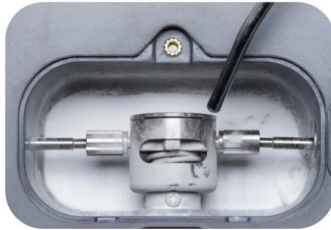
3. Elimine el polvo que queda en la cámara de la válvula de presión con una pistola de aire.
