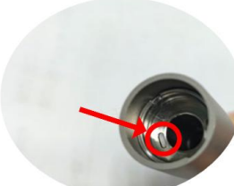
5.Limpie con un bastoncillo de algodón humedecido en alcohol.
