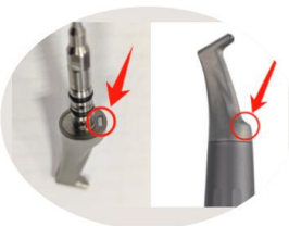
4.Limpie con un bastoncillo de algodón humedecido en alcohol.
